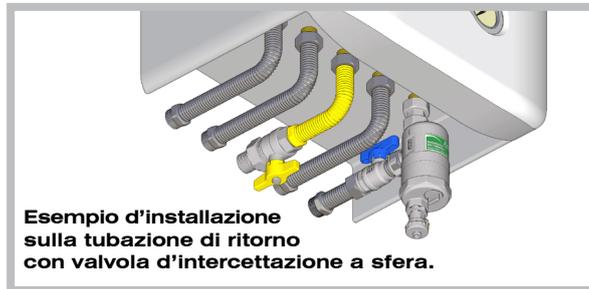
Esempio d'installazione sulla tubazione di ritorno con valvola d'intercettazione a sfera.
