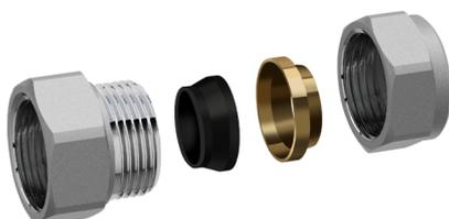
Il niplex per tubo rame Ø18 **art.5807 34G18**, in ottone cromato e completo di tenuta in gomma permette la connessione diretta del defangatore con i tubi in rame.
